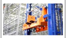
堆垛机系公司自有专利产品,主要应用于自动 化立体仓库,由行走电机通过驱动轴带动车轮 在下导轨上做水平行走,由提升电机通过钢丝 绳或链条带动载货台做垂直升降运动,由载货 台上的货叉做伸缩运动。通过上述三维运动可 将指定货位的货物取出或将货物送入指定货
