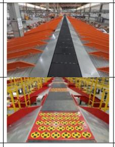
直线交叉带分拣设备系公司自有专利产品,应用场景与环形交叉带类似,当场地空间受限时可选用此类产品,主要由连续小车、主机、轨道、导入台、分拣格口、条码扫描器、直线电机、漏波电缆通讯系统和供电系统等设备组成,在垂直方向上单向直线运动,由扫描器读码、数据库地址查询后,通过小车皮带的动作平滑地将货件卸载到指定格口。
