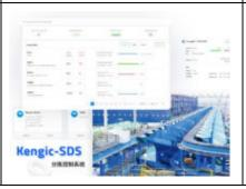
SDS 是公司自主研发的软件系统,用于高速分拣控制,通过对各种自动化设备的控制,实现货物的高速高效分拣。适用于交叉带分拣机、转向轮分拣机、模组带分拣机等产品,涉及快递、电商、物流等多个行业。SDS 系统支持多种接口方式,将分拣信息准确无误的上传给客户的上位系统,方便追踪货物的运动轨迹,并通过可定制的可视化报表,为客户生产提供决策。
